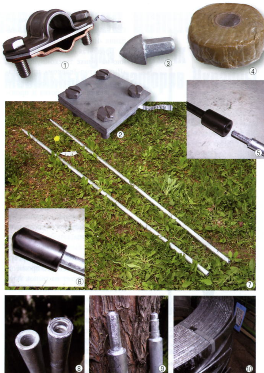
Рис. 9. Элементы модульной системы OBO Bettermann для соединения «стержень в стержень»: 1, 2 — зажимы; 3 — боек шпильчатого заземлителя; 4 — противокоррозионная лента; 5, 6 — насадка и обушок для забивания стержней вручную и вибромолотом; 7 — стержни; 8 — отверстие замка стержня (справа виден облой от свинцового уплотнительного кольца); 9 — цапфа замка (верхняя часть) стержня; 10 — плоский провод для горизонтального соединения стержней.
