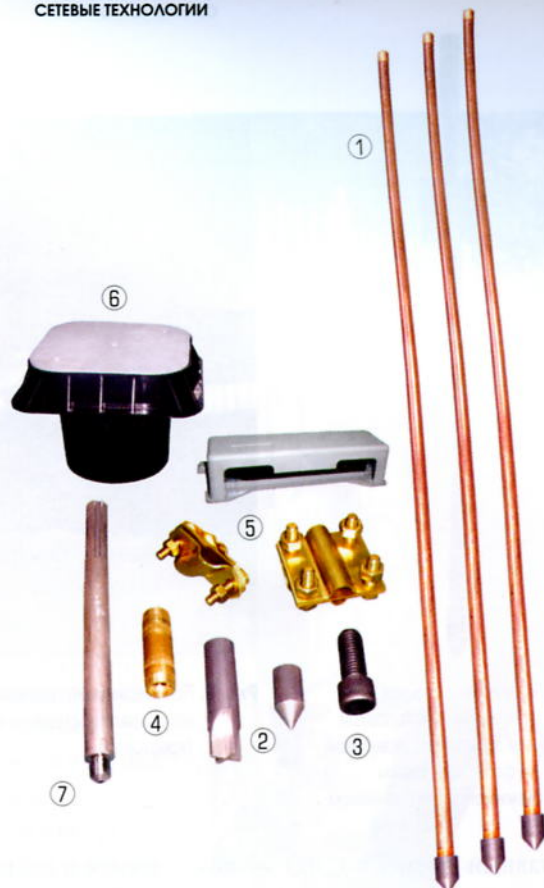
Рис. 1. Некоторые компоненты системы модульного заземления на примере продукции Galmar: 1 — стержень; 2 — наконечники; 3 — ударная головка; 4 — муфта; 5 — зажимы; 6 — смотровое устройство; 7 — насадка для вибромолотка
